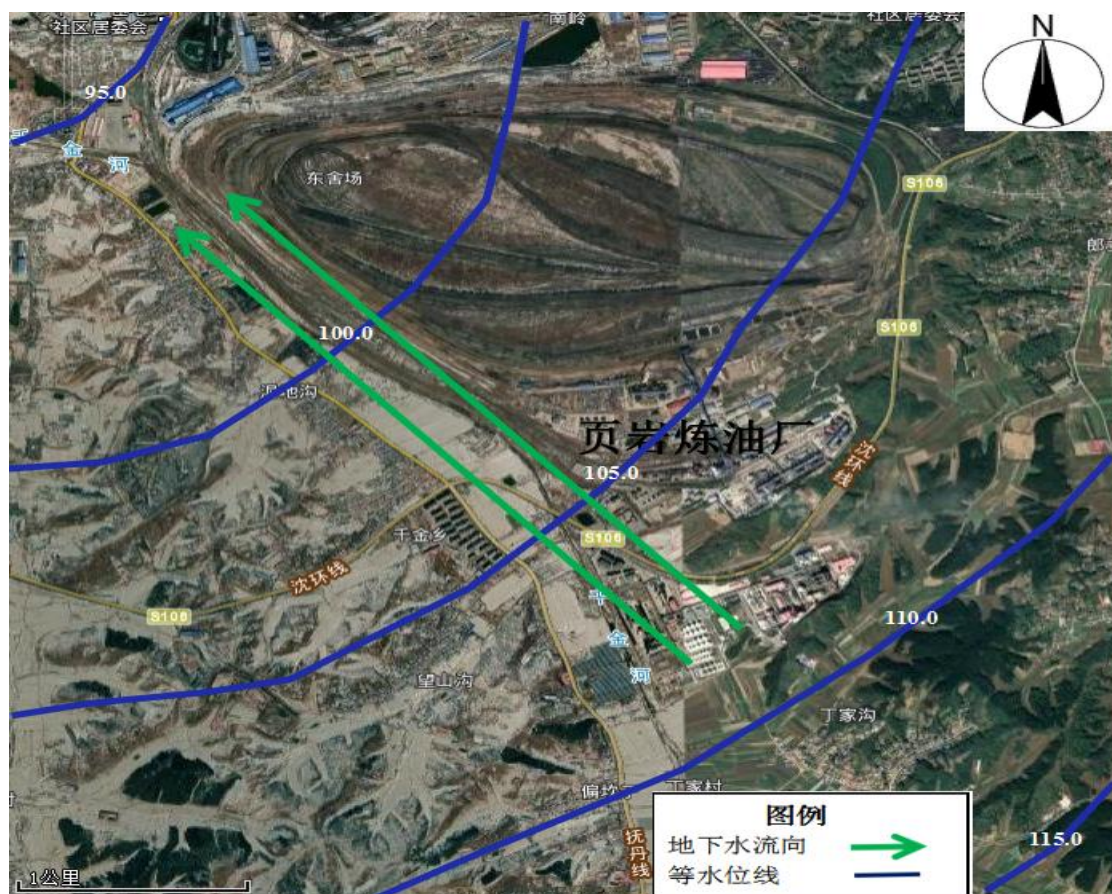
图 3-5 本工程周边地下水等水位线及地下水流向示意图
